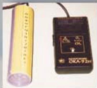
Газоанализатор "ОКА-92М" портативный предназначен для измерения объемной доли кислорода в воздухе - колодцах, коллекторах, и т.п. и сигнализации об уменьшении содержания кислорода ниже допустимого или увеличении содержания горячих газов выше допустимого предела.
