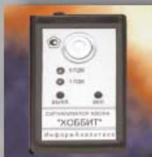
Газоанализатор содержания окиси углерода "Хоббит-Т-400" предназначен для измерения содержания окиси углерода в воздухе рабочей зоны и сигнализации о превышении его содержанием уровней 1 ПДК (20 мг/м<sup>3</sup>), и 5 ПДК (100 мг/м<sup>3</sup>). Газоанализатор предназначен для обеспечения безопасных условий труда в соответствии с инструкцией РД-12-341-00, введенной постановлением Госгортехнадзора РФ в действие с 01.05.00.
